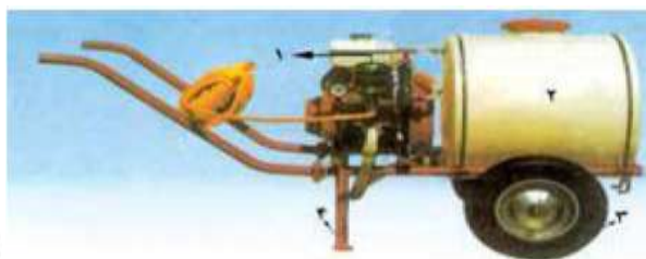
۱- موتور ۲- مخزن ۳- چرخ ۴- پایه ۵- شلنگ میانی مخزن ۶- پمپ تنظیم فشار ۷- گیج هوا یا یکم اخت کننده فشار ۸- فشارسنج ۹- شیرهای خروجی ۱۰- نازل
