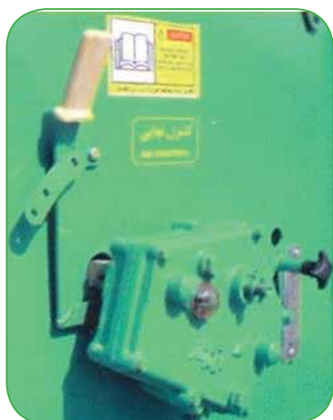
عکس شماره ۲۰ گیربکس تنظیم دستگاه
