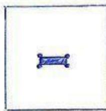
\* اگر میل کرد کوچکی را برای بالابردن جسمی فولادی به آن جوش همیم بعلّت بالارفتن دمای آن در موقع سرد شدن یک تنش باقیمانده حرارتی ذخیره می‌شود.
