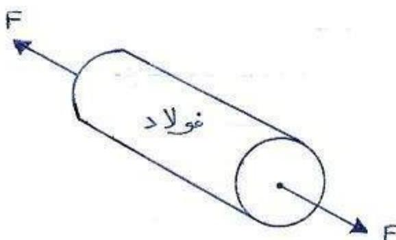
\* تعریف مقاومت تنفس بحسب نیروی محوری - صحیح نیست بلکه به سطح مقطع هم جستگی دارد.
