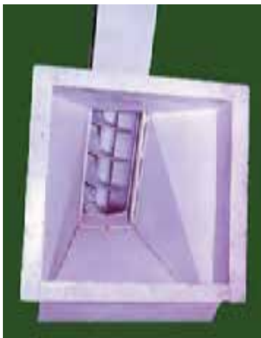
شکل ۱۵-۱- دریچهٔ ورودی نقاله
