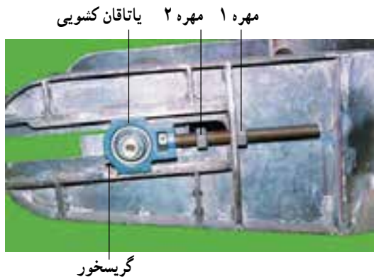
شکل ۱۱-۱- تنظیم کننده کشیدگی تسمه نقاله
