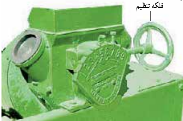
شکل ۱۳-۲- تنظیم کننده فاصله ناودانی و پوسته حفره‌دار
